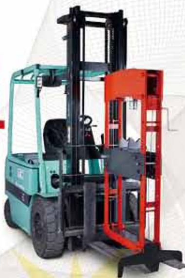
Husillo extensible para un acercamiento más rápido y preciso a la posición de trabajo.
