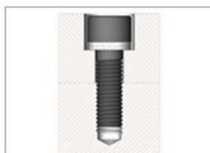
Tornillo cilíndrico asegurado (avellanado)
